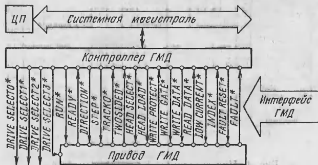
Рис. 1. Связь привода ГМД с микроЭВМ
